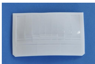
型号: SIR 650P 尺寸: 59.5*39 焦距: 30mm 感应角度: 90-100° 感应距离: 12m
