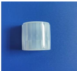
型号: LC-2818 尺寸: 31.3*27.7*19.9 焦距: 13mm 感应角度: 120° 感应距离: 10m
