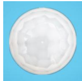
型号: 01809-2 尺寸: 17.8*11.95 焦距: 9mm 感应角度: 120^\circ 感应距离: 8m
