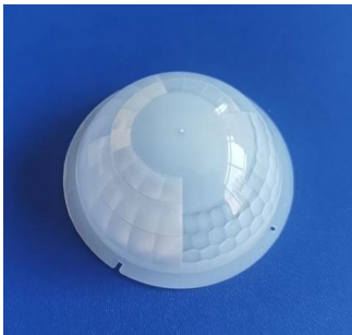
型号:YY-D52 尺寸: \varnothing 52 焦距: 17mm 感应角度: 240^{\circ} 感应距离: 17m 备注: 适用于泛光灯
