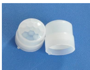
型号: 8308-6 尺寸: 13.6 \times 15.5 焦距: 9.6mm 感应角度: 90^\circ 感应距离: 8m
