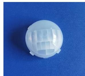
型号: YY-2311 尺寸: \varnothing 12.5 焦距: 11mm 感应角度: 120^\circ 感应距离: 10m
