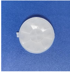
型号:YY-1202 尺寸: \varnothing 22.4 焦距: 11mm 感应角度: 360^{\circ} 感应距离: 10m 吸顶 6m
