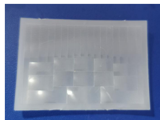
型号: YY-DWA-V2 尺寸: 42.6*61 焦距: 30.5mm 感应角度: 101° 感应距离: 9m
