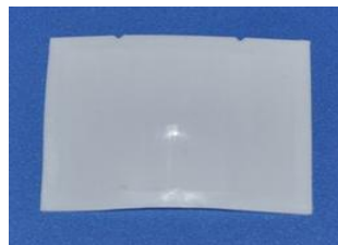
型号: 8203-1 尺寸: 56*44 焦距: 25mm 感应角度: 110° 感应距离: 12m
