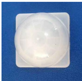
型号: 023100 去腿 尺寸: 23.4*23.4*18.9 焦距: 10.5mm 感应角度: 120° 感应距离: 10m
