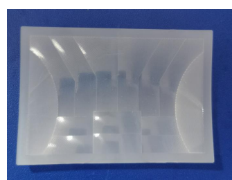
型号: YY-LR-V2 尺寸: 42.6*61 焦距: 30.5mm 感应角度: 154° 感应距离: 28m
