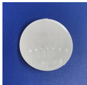
型号:GB-01-3640 尺寸: \varnothing 40 焦距: 12mm 感应角度: 90° 感应距离: 12-16m
