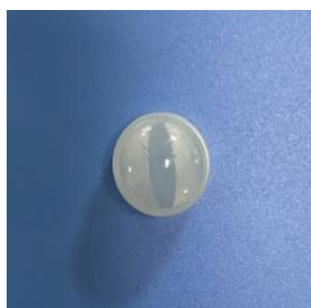
型号: 8121-2 尺寸: \Phi 9.8 焦距: 5.2mm 感应角度: 120^\circ 感应距离: 9m
