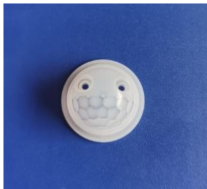
型号: SC-01 (复眼) 尺寸: \varnothing 30.3 \times 21.1 焦距: 10mm 感应角度: 120^\circ 感应距离: 8m
