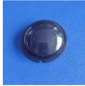
型号:YY-2010-20 尺寸: \varnothing 23.6 \times 7.6 焦距: 10mm 感应角度: 120^\circ 感应距离: 10m
