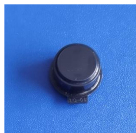
型号: LQ-01 尺寸: \Phi 15.57 \times 8.45 焦距: 4mm 感应角度: 90^\circ 感应距离: 2-3m
