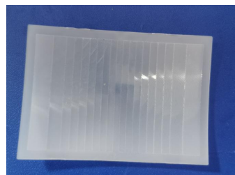
型号: YY-AA-V1 尺寸: 42.6*61 焦距: 30.5mm 感应角度: 155° 感应距离: 15m
