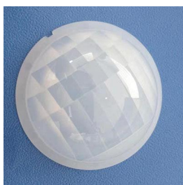
型号: YY-3015 尺寸: \Phi 34*15 焦距: 15mm 感应角度: 135^\circ 感应距离: 12m
