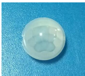
型号: 13120F-5 尺寸: \Phi 13.7 \times 6.6 焦距: 6mm 感应角度: 120^\circ 感应距离: 7m
