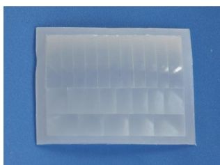
型号: 7708-3 尺寸: 58*45 焦距: 29.7mm 感应角度: 80 ° 感应距离: 14m
