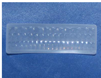
型号: 8526-1 尺寸: 84.7*25.6 焦距: 23mm 感应角度: 120° 感应距离: 14m
