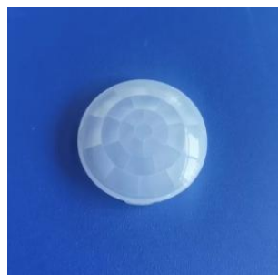
型号:LTX-01 尺寸: \varnothing 33.05 \times 9.75 焦距: 12.7mm 感应角度: 120° 感应距离: 5m
