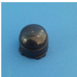
型号: 8308-8G 尺寸: 10.4*9.5 焦距: 4mm 感应角度: 40^\circ 感应距离: 5m
