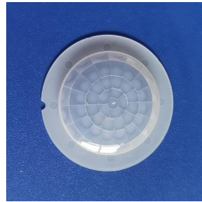
型号:YY-D36 尺寸: \varnothing 36 \times 7.2 焦距: 17.5mm 感应角度: 360^{\circ} 感应距离: 10m
