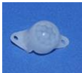
型号: 2134-1 尺寸: 26.8*15*17.1 焦距: 7.5mm 感应角度: 120 ° 感应距离: 5m
