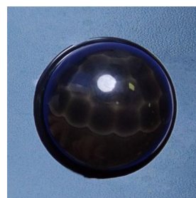
型号: YY-023115-25 尺寸: \Phi 26*17.2 焦距: 11.5mm 感应角度: 120^\circ 感应距离: 10m
