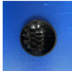
型号: YY-4015 尺寸: \varnothing 43 焦距: 15mm 感应角度: 120^\circ 感应距离: 15m
