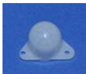
型号: 2135-1 尺寸: 25*15*17 焦距: 7.5mm 感应角度: 120 ° 感应距离: 6m
