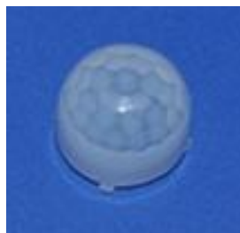
型号: 8003-1 尺寸: \phi 22.7*18.6 焦距: 10.5mm 感应角度: 100° 感应距离: 10m
