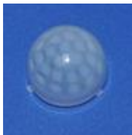
型号: 9002-1.7 尺寸: \phi 24*20 焦距: 12mm 感应角度: 360 ° 感应距离: \phi 10m
