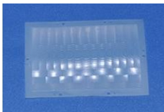
型号: 614230 尺寸: 60.7*42.4 焦距: 30.5mm 感应角度: 90 ° 感应距离: 12m
