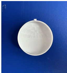
型号:YY-RG01 尺寸: \varnothing 39.8 \times 7.7 焦距: 12mm 感应角度: 120^\circ - 130^\circ 感应距离: 8m
