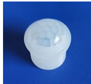
型号:YY-2311 尺寸: Ø23.22*12 焦距: 11mm 感应角度: 120° 感应距离: 10m 无纹区朝下, 放置 1.2m, 可防宠
